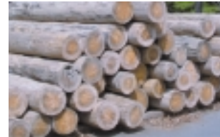
解体後、再利用のために運ばれた松杭
