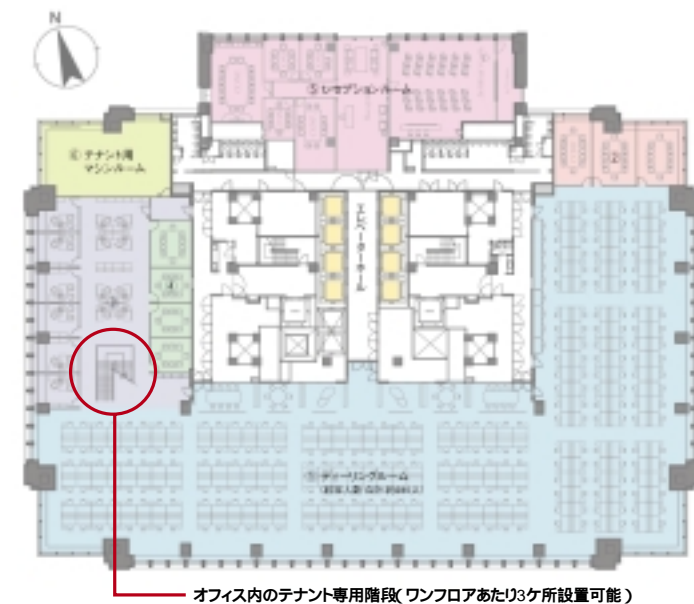
オフィス内のテナント専用階段(ワンフロアあたり3ヶ所設置可能)
